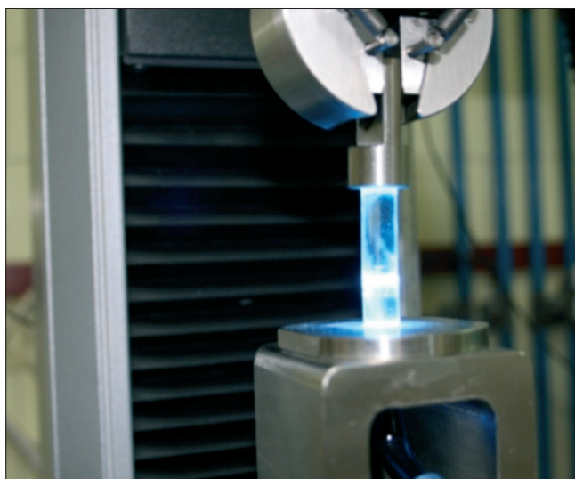
1. ábra: A polimerizációs zsugorodást mérőműszer központi része mérés közben
