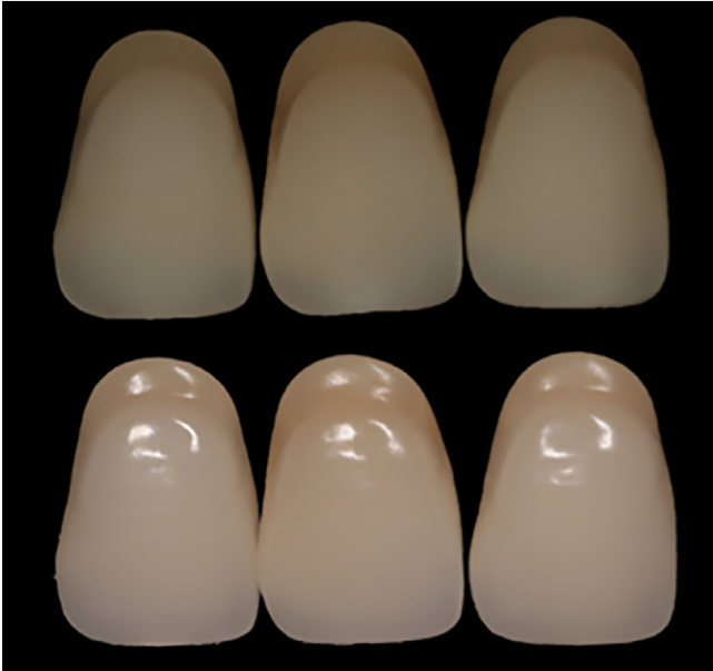
12. kép: VITA Classical D2-es fogszínkulcsok. Bal oldalt a referencia fogszínkulcs, középen és jobb oldalt az elszíneződött fogszínkulcsok láthatók. A felső képsor keresztpolarizációs szűrővel, az alsó képsor keresztpolarizációs szűrő nélkül készült.
