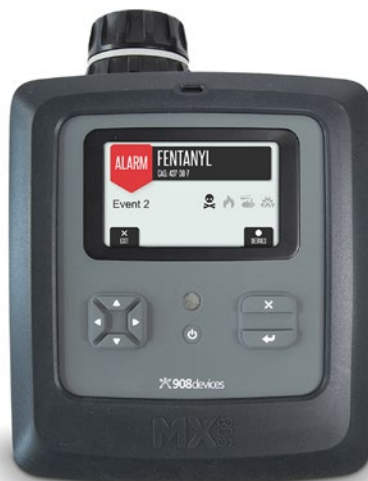
3. kép: MX-908 típusú, nagynyomású tömegspektrométer 7
