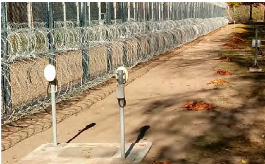
4. ábra: Kapacitív rendszer
