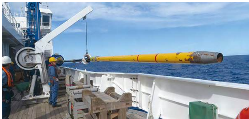
26. ábra. Hidraulikusan működő magvevő készülék
