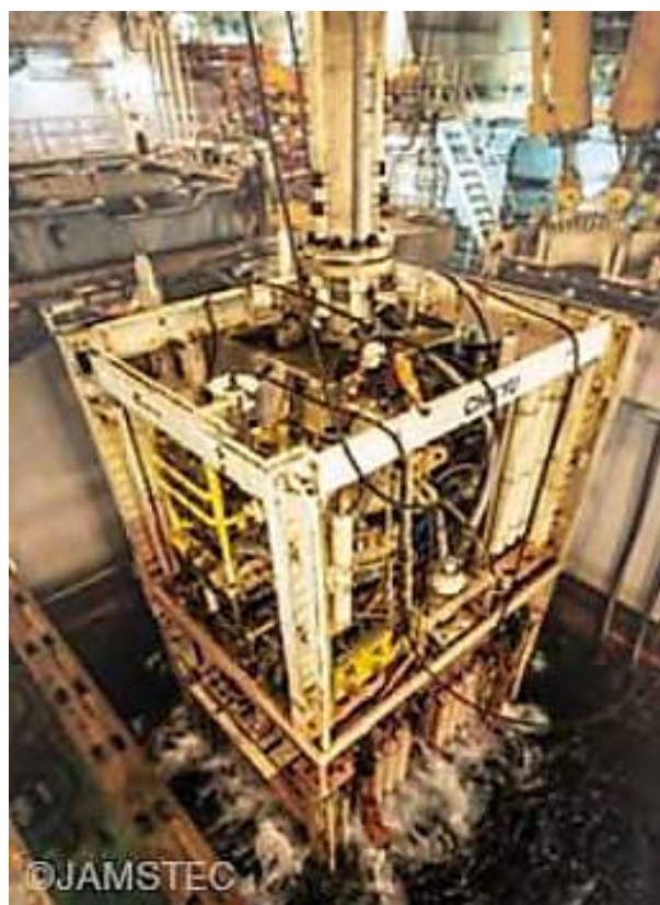
18. ábra. Kitörésgátló szerelvény a felszálló csővel
