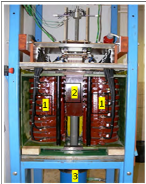
13. ábra. 2 pólusú TMF ikerinduktor (1) a kemencével (2) és a víztartállyal (3)
