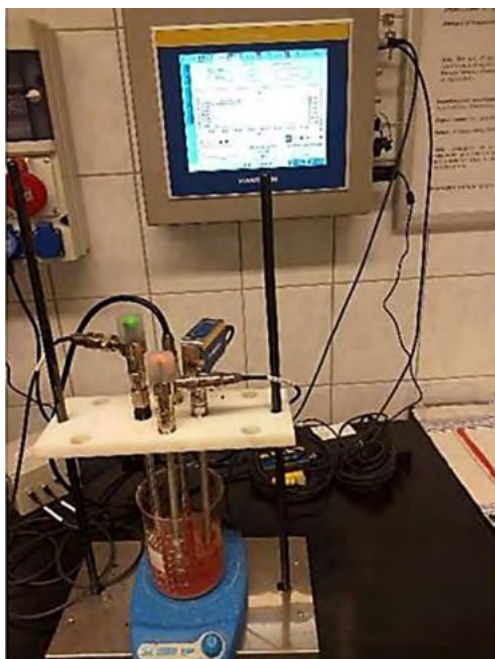
17. ábra. Hamilton sejtsűrűségmonitoring-rendszer a Bioeljárás-technikai Laboratóriumban (saját felvétel)
