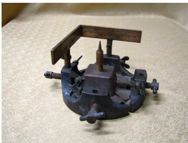
5. ábra. Soproni aknafüggélyező
