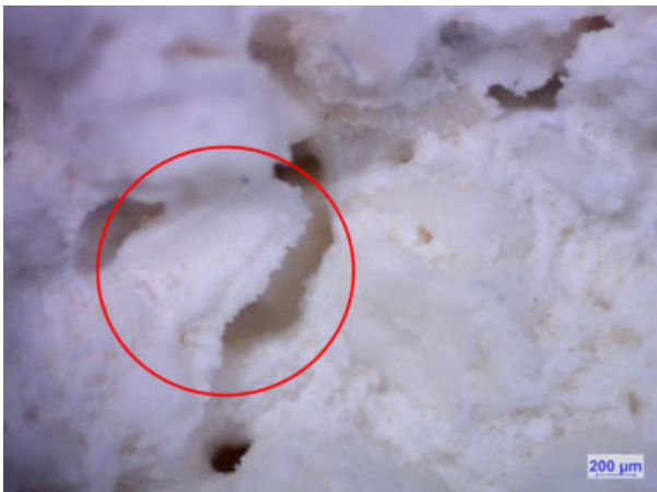
7. ábra. 850 °C-on 30 percig szinterelt hajlítópróbatest sztereomikroszkópos felvétele (3-as típusú törés)
