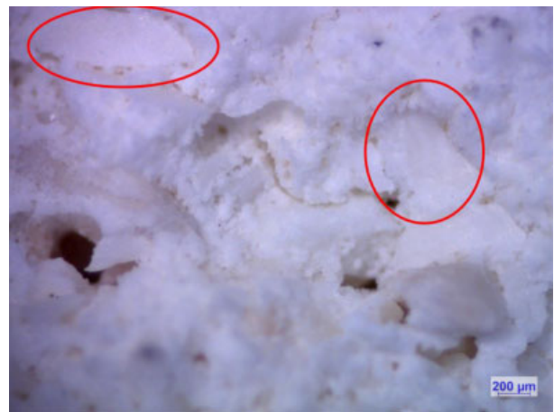
9. ábra. 1150 °C-on 4 órán át szinterelt hajlítópróbatest sztereomikroszkópos felvétele (1-es típusú törés)
