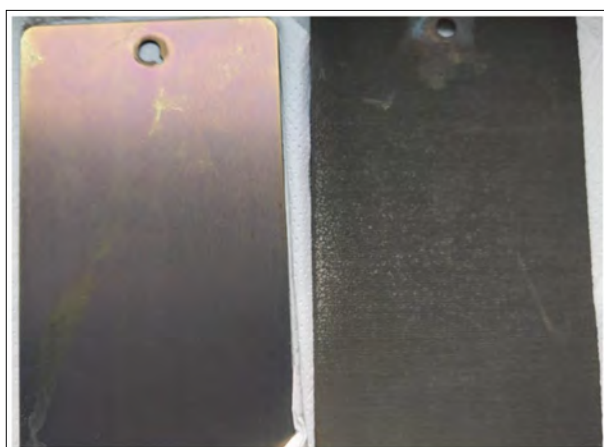
8. ábra. 1,5 g/L molibdénadalékos foszfátózó oldattal készített mintalemezek; balra Q-panel, jobbra öntöttvas mintalemez
