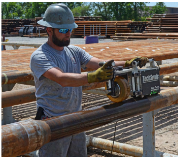
13. ábra. Ultrahangos vizsgálat
