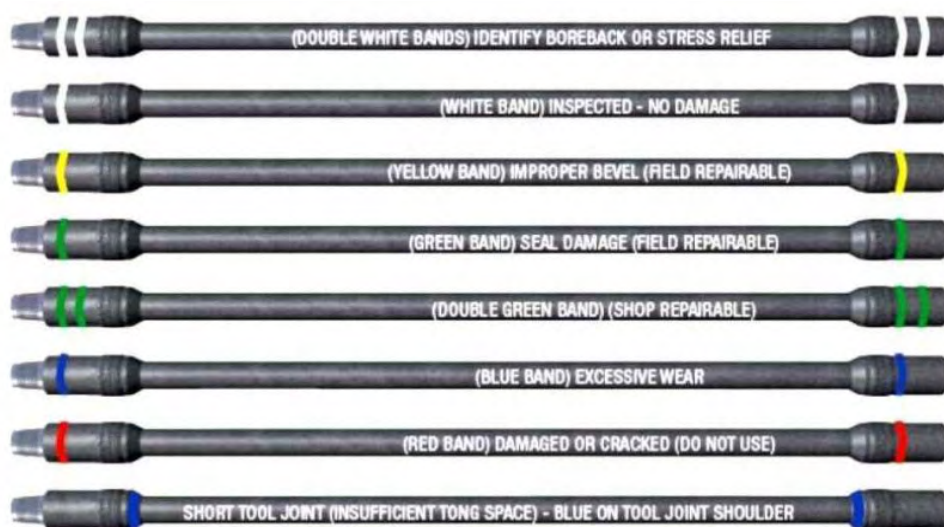
17. ábra. A fúrócsőkapcsoló állapota
