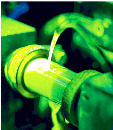
11. ábra. Nedves mágnesesrészecske-vizsgálat
