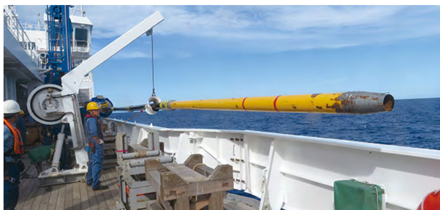
26. ábra. Hidraulikusan működő magvevő készülék
