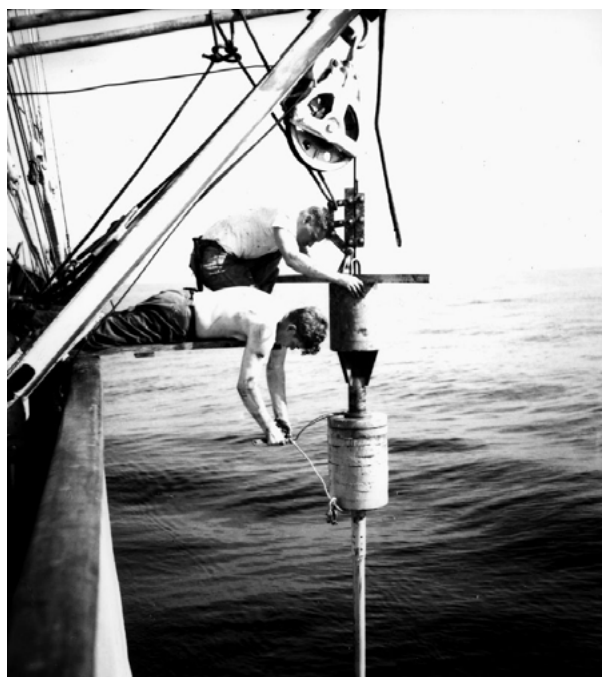
3. ábra. A dugattyús magvevő beépítése az Albatross kiképzőhajóról
