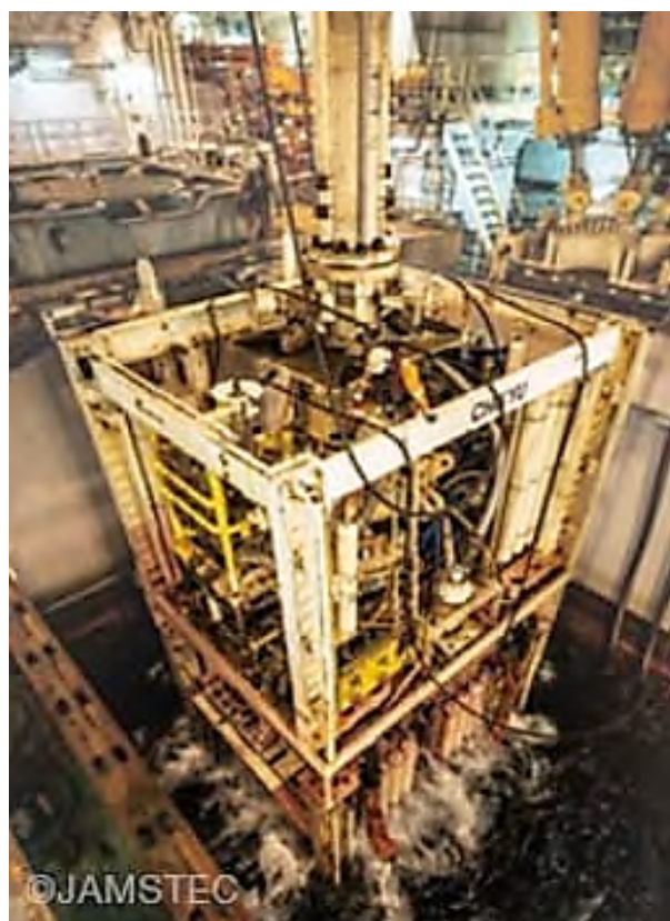
18. ábra. Kitörésgátló szerelvény a felszálló csővel
