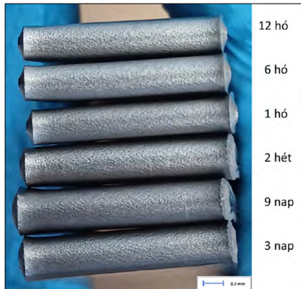
2. ábra. A hajlított próbatestek külső ívéhez tartozó felületről készült makrofotó
