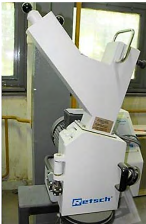
12. ábra. Vágómalom az Intézetben (web: Nyersanyag-előkészítés és Környezettechnológia Intézet honlapja)
