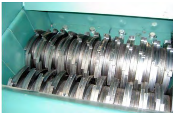
9. ábra. Forgótárcsás nyírómű felülnézete (Faitli és társai, 2017)
