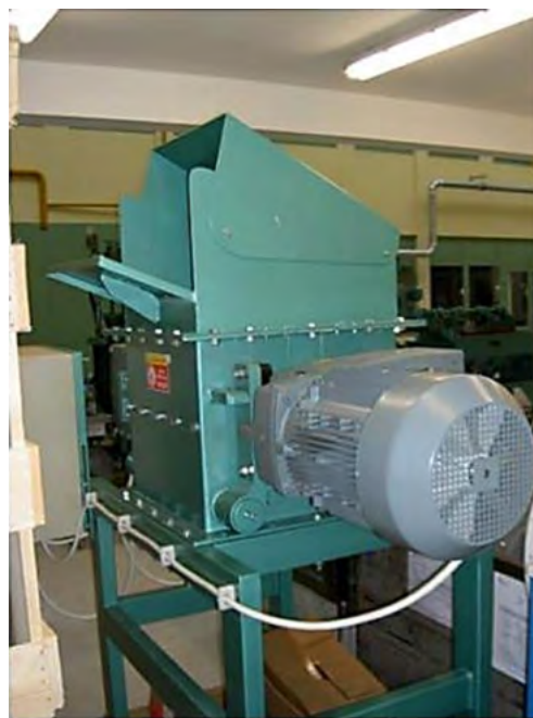
8. ábra. Forgótárcsás nyírómű a laboratóriumban (web: Nyersanyag-előkészítés és Környezettechnológia Intézet honlapja)
