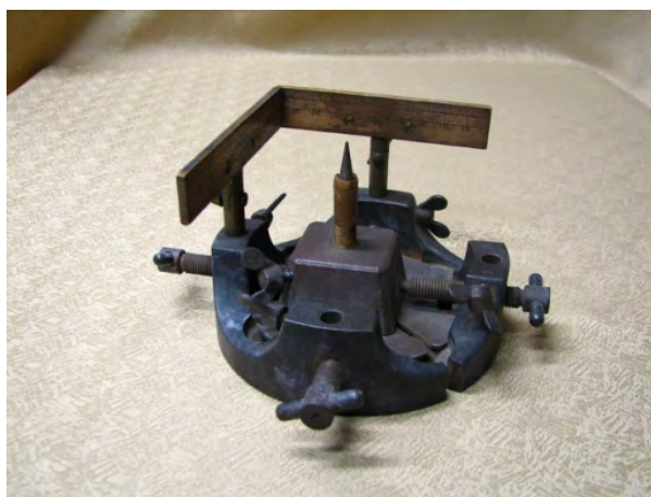
5. ábra. Soproni aknafüggélyező
