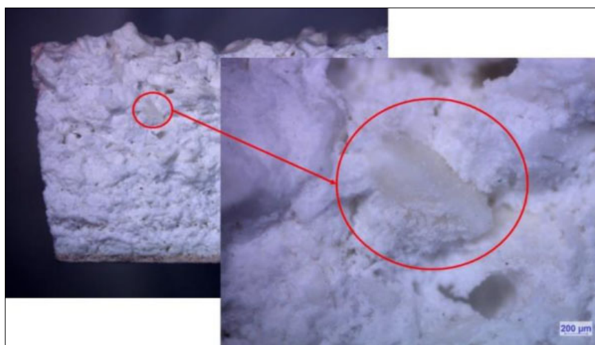
6. ábra. Viaszkiolvasztott hajlítópróbatest sztereomikroszkópos felvétele (2-es típusú törés)
