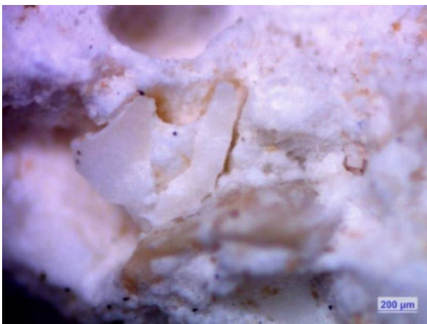
8. ábra. 1050 °C-on 4 órán át szinterelt hajlítópróbatest sztereomikroszkópos felvétele (1-es típusú törés)
