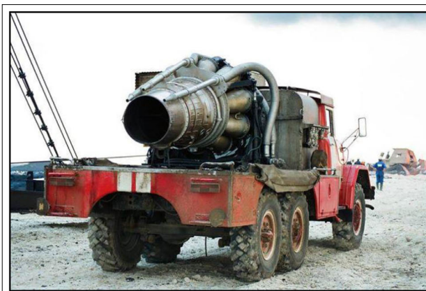
10. kép. A turboreaktív oltógép és tűzoltása
