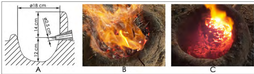
2. ábra. A szeghegestűs kísérlet oldalszeles kovácstűzhelyben. A) Méretek. B) Szegadag az izzó faszén kupac tetején. C) A fűvóka alatt-előtt összeállt salakos vasbuca a kísérlet végén
