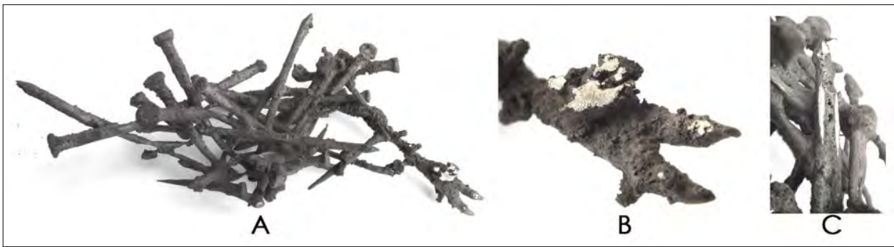
5. ábra. A) A kovácstűz fűvósíkja fölül kivett, részben elégett, összehegedt szegek. B) Szivacsos felrakódás a szegek felületén. C) Részben elsalakult szegek
